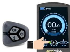
Halten Sie die „MINUS“-Taste gedrückt, um den Motor zu starten, der ohne Treten mit 6 km / h fährt. Das Display zeigt das Symbol wie im nebenstehenden Bild. Wenn der Benutzer die Taste loslässt, wird der Motor automatisch abgeschaltet.
