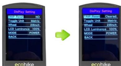
Trip Reset bedeutet Zurücksetzen der Tagesstrecke. Um die Tageskilometer zurückzusetzen, drücken Sie die „+“-Taste oder die „-“-Taste, um Ja / Nein auszuwählen. JA bedeutet, dass die Tageskilometer zurückgesetzt werden. NEIN bedeutet keine Reinigungsstrecke. Um die geänderte Einstellung zu speichern, drücken Sie die „i“-Taste. Der Standardwert ist NEIN.
