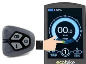
Zeigt die Leistung an, mit der der Motor arbeitet, wenn der gesamte Leistungsbalken angezeigt wird, bedeutet dies, dass der Motor mit voller Leistung arbeitet. Der Akku ist dann schneller entladen.
