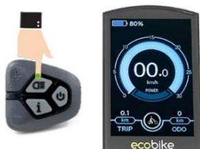
Klicken Sie bei eingeschaltetem Display gleichzeitig auf die Beleuchtungstaste, um die Hintergrundbeleuchtung des Displays sowie die Vorder- und Rücklichter einzuschalten. Klicken Sie erneut auf die Schaltfläche, um die Hintergrundbeleuchtung und die Lichter auszuschalten. Wenn das Licht eingeschaltet ist, sehen Sie das Symbol auf dem Bildschirm wie im nebenstehenden Bild.
